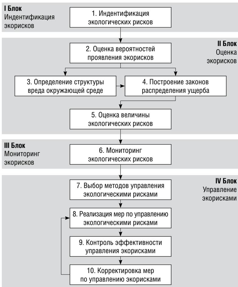
**Рис. 3.1.** Блок-схема последовательности анализа экологических рисков
